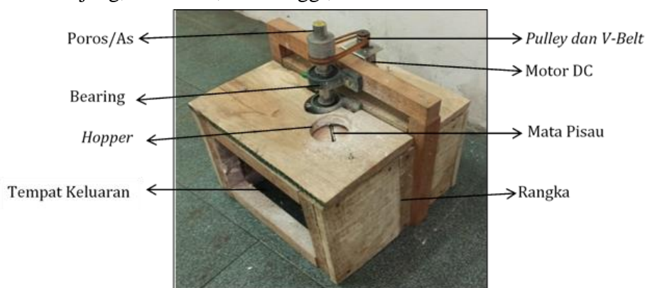
Gambar 3. Kontruksi Alat Perajang Singkong Tipe Horisontal Bertenaga Motor DC
