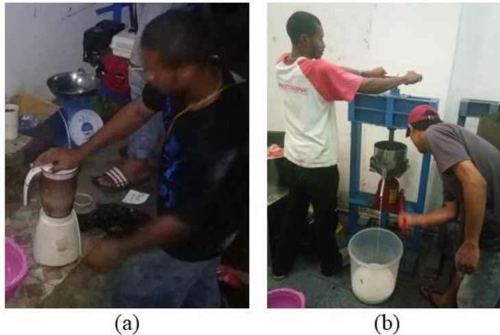
Gambar 9. Sampel ampas 200 gr ditambahkan air 400 ml diblender selama 4 menit (a) kemudian diekstraksi kandungan santan menggunakan alat press hidrolik manual (b)
