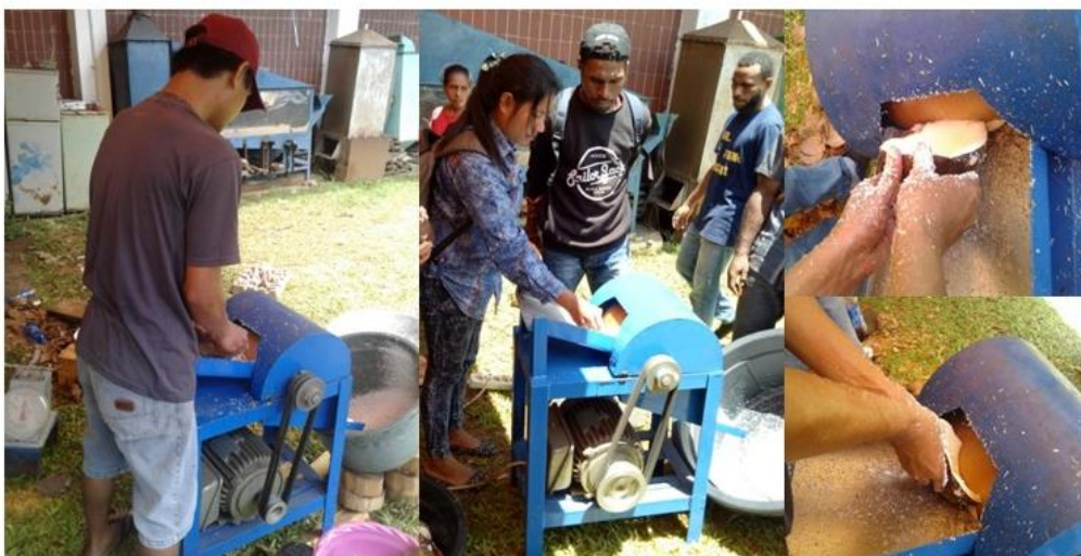
Gambar 7. Pengoperasian mesin parut kelapatipe silinder bertenaga motor listrik
